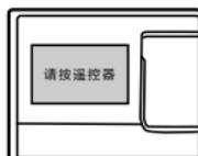
依据提示操作：请按遥控器开门按钮，语音提示“操作成功”，如需再添加遥控器请继续按提示操作。或按“\*”返回上层菜单。（不能重复添加同一遥控器，且遥控器编号不能重复使用）
