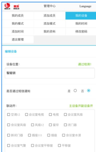
在“我的设备”内找到“客厅指纹锁”对设备进行“编辑”，选择“短信通知”，指纹锁开启后便会有开锁信息提示。
