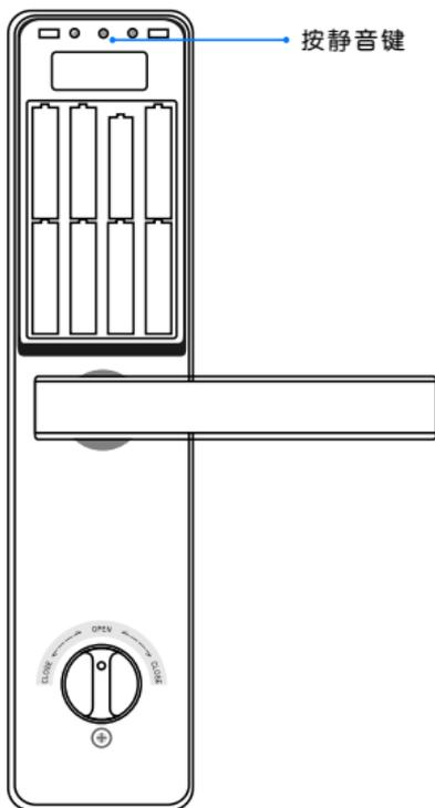
按下指纹锁的静音键发送配对ID，控制器接收到配对ID后绿灯变为慢闪；再次按下指纹锁的静音键，控制器第二次收到配对ID并校验，配对成功后绿灯常亮。
