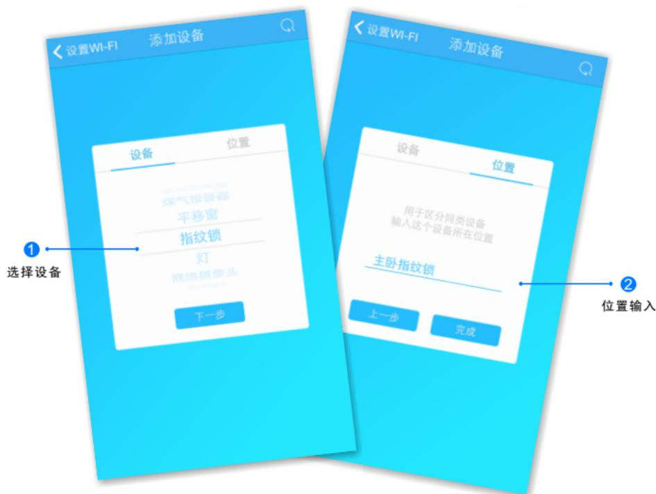
搜索设备成功后，“设备”自动跳转至“指纹锁”，点击“下一步”跳转至“位置”，输入设备位置名称如“主卧指纹锁”，点击“完成”，设备位置添加成功。
