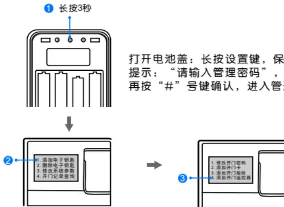
打开电池盖：长按设置键，保持3秒①，当语音提示：“请输入管理密码”，输入管理密码，再按“#”号键确认，进入管理模式。
