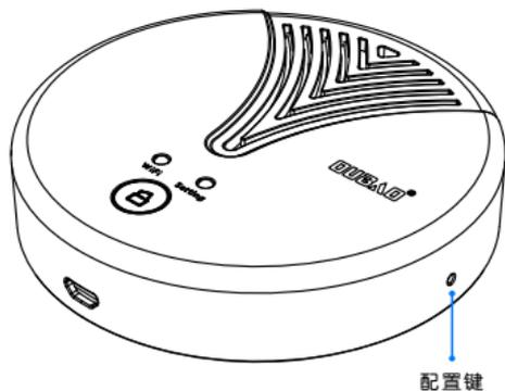
**配置：**按一下指纹锁控制器上的“配置键”，蓝色WIFI指示灯快闪，则设备进入配置状态。
