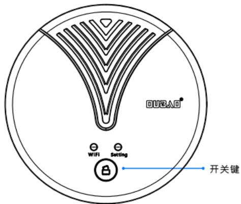
长按指纹锁控制器的开关键至绿灯快闪，松开按键，控制器进入指纹锁配对状态。
